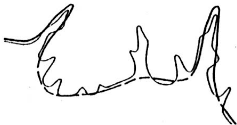
Obr. 4.1 Príklad zjednodušenia priebehu vrstevnice
